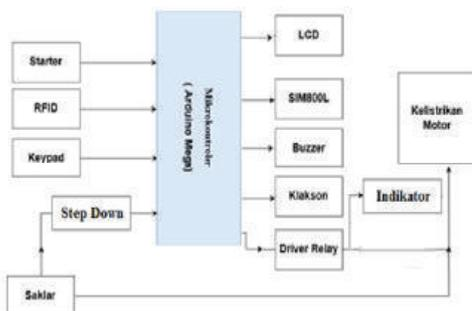
**Gambar 2.** Diagram Blok Rangkaian Pengaman
