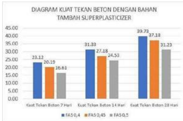
Gambar 6. Diagram Perbandingan Nilai Kuat Tekan Beton Dengan Bahan Tambah Superplasticizer Berdasarkan Nilai Faktor Air Semen
