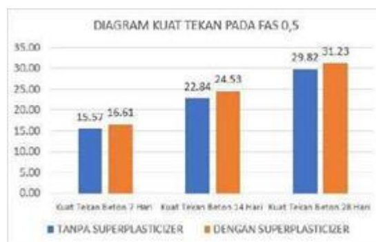
Gambar 5. Diagram Perbandingan Nilai Kuat Tekan Beton Pada FAS 0,5
