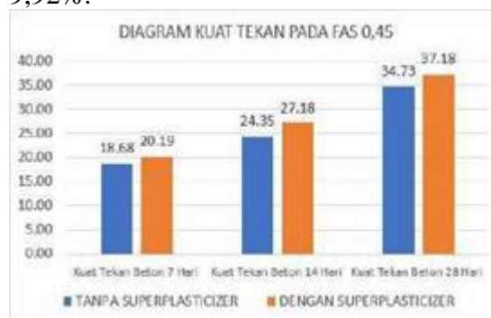
Gambar 4. Diagram Perbandingan Nilai Kuat Tekan Beton Pada FAS 0,45
