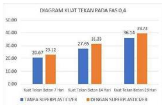
Gambar 3. Diagram Perbandingan Nilai Kuat Tekan Beton Pada FAS 0,4
