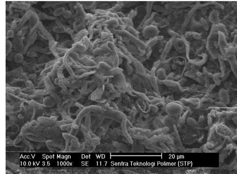
**Gambar 3.** Foto struktur mikro sebelum penambahan filler *nanoclay* sampel PET/PP/C7
