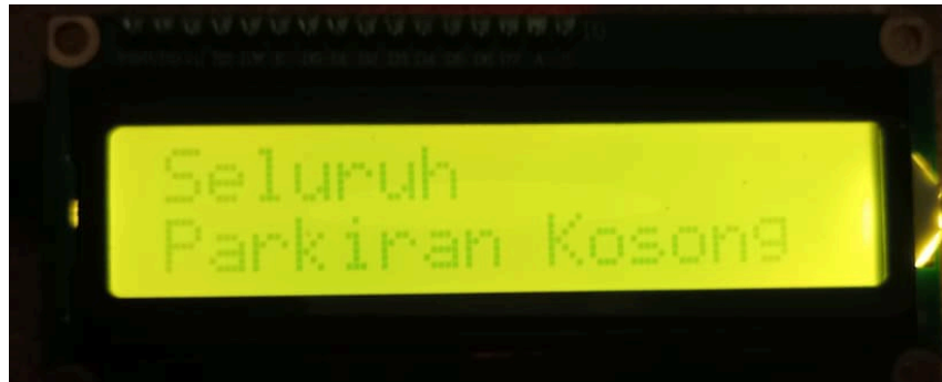
Gambar 5: Tampilan LCD saat seluruh slot parkir kosong
