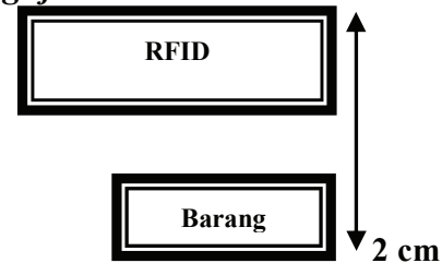
Gambar 6. Pengambilan Data Jarak Deteksi RFID Reader
