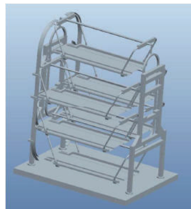
Gambar 6. Prototipe Sistem Parkir Mobil Berputar
