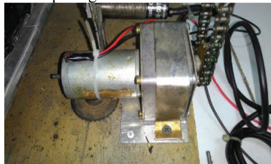
Gambar 25. Penempatan Motor DC
