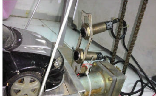
Gambar 24. Penempatan Photo Sensor
