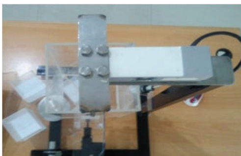
Gambar 13. Peletakan Load Cell
