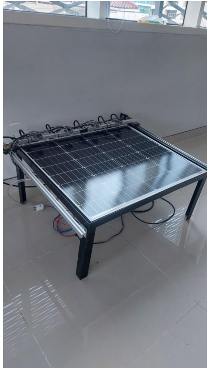
Gambar 5. Desain Hardware Sistem Pembersih Panel Surya Otomatis Berbasis Internet Of Things (IoT) (Sumber: Peneliti, 2025)
