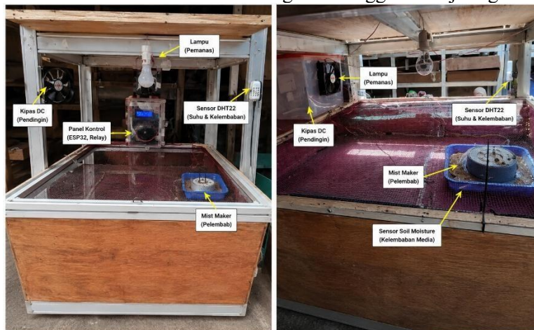
Gambar 5. Implementasi Sistem Monitoring dan Pengendalian Suhu serta Kelembaban pada Budidaya Maggot
