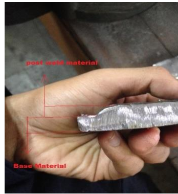
Gambar 2. Perbedaan tebal Pre dan Post Weld
