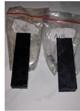
Gambar 3. Spesimen Hasil Quenching Oli dan Air
