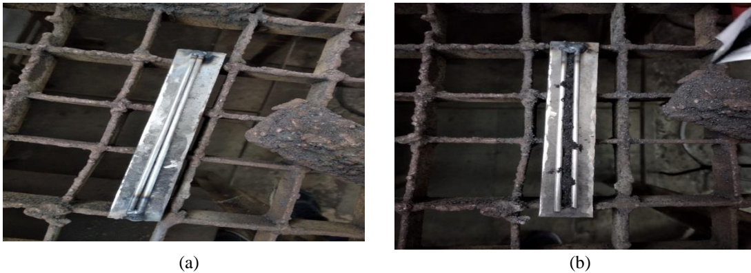
Gambar 1. Proses preparasi pengelasan (a) E60, dan (b) E60+C
