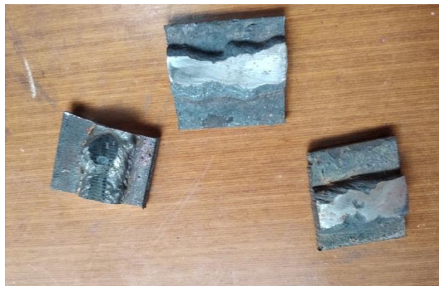
Gambar 3. Hasil pemotongan dan perataan permukaan spesimen pengelasan
