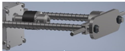
Gambar 3. Desain Alat Bantu Senai Pada Mesin Bor Portabel
