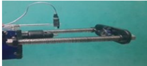
Gambar 8. Penambahan Pemegang Senai Pada Mesin Portabel
