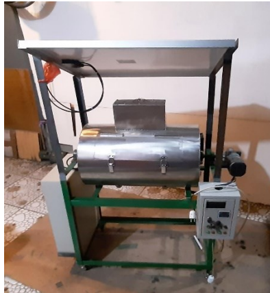
Gambar 2. Hasil Rancangan Mesin Pengering
