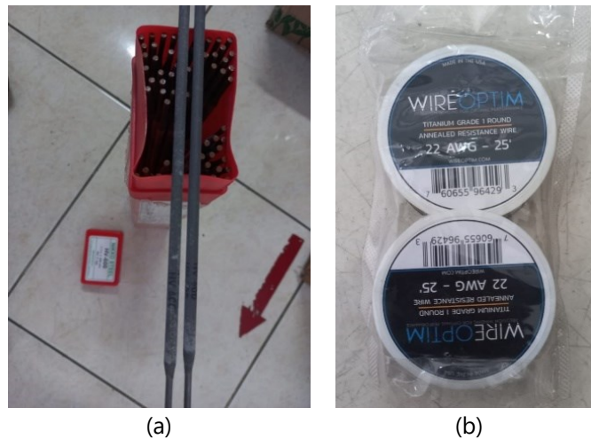
Gambar 3. Filler Metal (a) Elektroda HV 600 dan (b) Kawat Ti Logam induk
