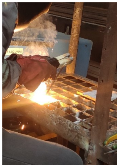
Gambar 2. Proses Pengelasan Spesimen Penelitian
