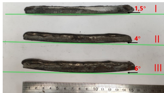
Gambar 5. Distorsi Spesimen Pengelasan
