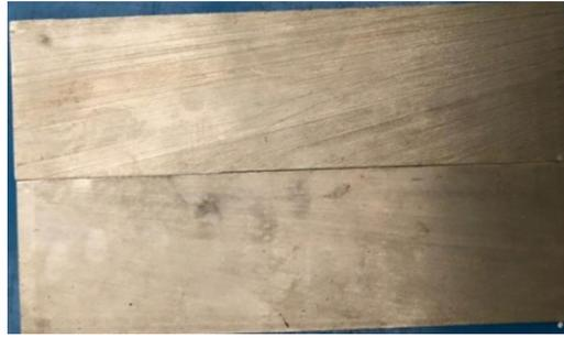
**Gambar 2.** Hasil Potongan Pelat AISI 1045 Dimensi 250 × 75 × 6 mm
