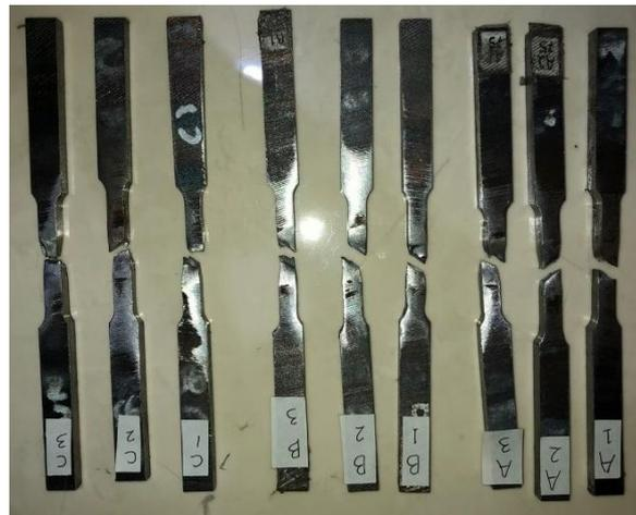
**Gambar 8.** Patahan Spesimen Uji Kuat Tarik
