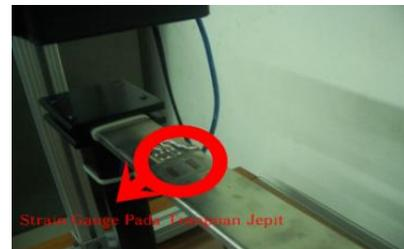
Gambar 2.3. *Strain gauge* pada tumpuan jepit
