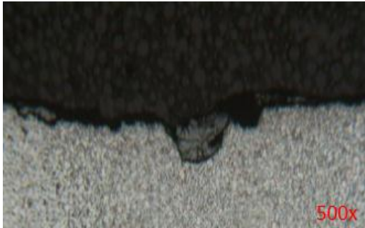
Gambar 5. Struktur mikro dgn perbesaran pada sambungan las ERW berupa ferit-perlit Dan Bentuk serangan korosi celah
