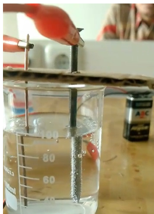
Gambar 2. Percobaan elektrokimia menggunakan batang tembaga dan paku besi serta air cuka
