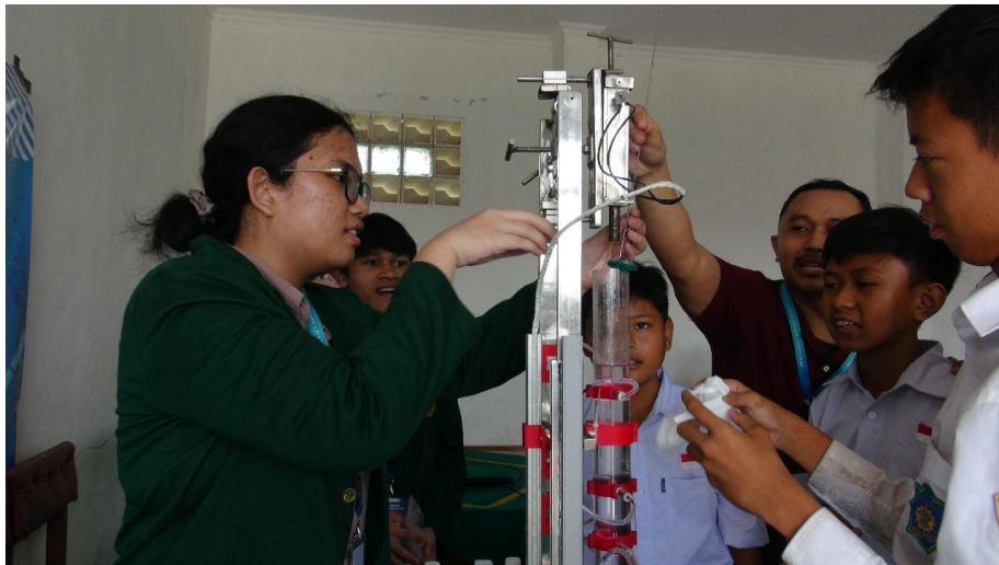
GAMBAR 2. Praktikum Viskositas Menggunakan Alat Pengukuran Viskositas Berbasis Arduino
