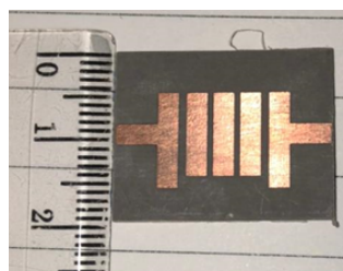
Gambar 10d. Filter interdigital mikrostrip fabrikasi dengan open stub dan defected ground structure lebar filter fabrikasi
