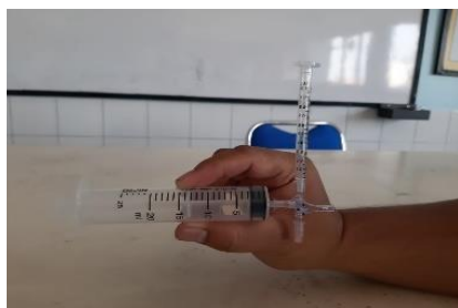
Gambar 3. Sistem titrasi microscale
