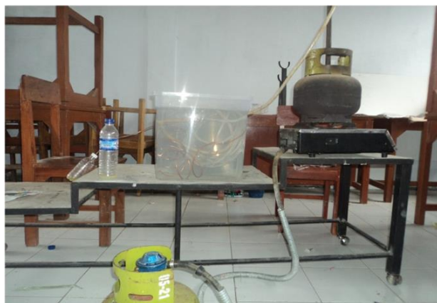
Gambar 1 Rangkaian Alat Pirolisis Sederhana
