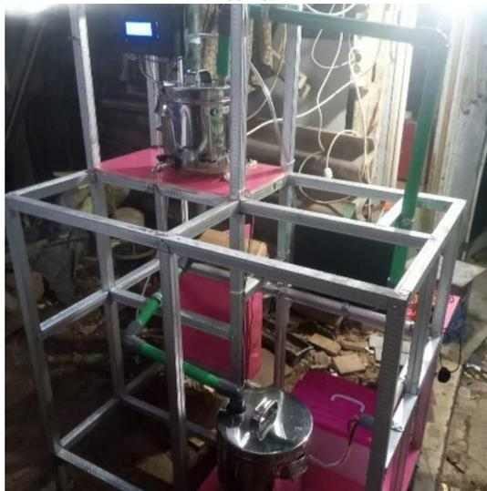
**Gambar 3.** Hasil Realisasi Rancangan Alat Penyulingan Air Laut Menjadi Air Tawar dengan Proses Distilasi Sederhana Berbasis Arduino.
