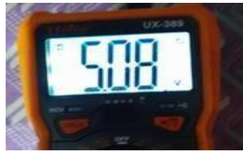
Gambar 6. Hasil Pengukuran Tegangan Input Pada Regulator Step Down
