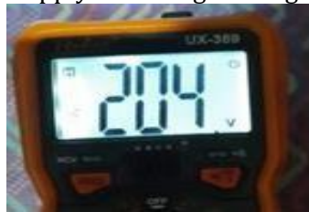
Gambar 3. Hasil Pengukuran Tegangan Input Pada Power Supply Switching
