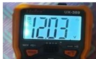
Gambar 4. Hasil Pengukuran Tegangan Output Pada Power Supply Switching
