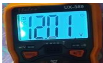
Gambar 5. Hasil Pengukuran Tegangan Input Pada Regulator Step Down
