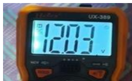
Gambar 10. Hasil Pengukuran Tegangan Output Pada Power Supply Switching
