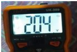
Gambar 9. Hasil Pengukuran Tegangan Input Pada Power Supply Switching
