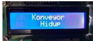
Gambar 13. Hasil Pengujian Sensor Infrared dengan LCD
