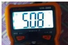
Gambar 12. Hasil Pengukuran Tegangan Input Pada Regulator Step Down
