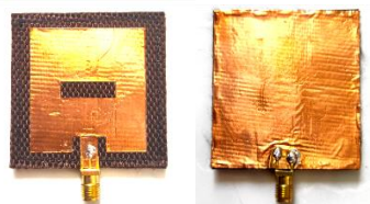
Gambar 4.5 Hasil Fabrikasi Antena Tekstil Cordura
