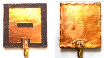
Gambar 8. Hasil fabrikasi antena tekstil cordura
