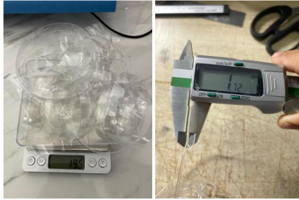
Gambar 6. Lembaran PET Hasil Pematangan dan Pengukuran Diameter Material Berbentuk Filamen
