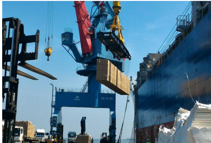
Gambar 3. Spreader mengangkat muatan Sumber: PT. Daisy Mutiara Samudra
