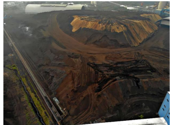
Gambar 1. Coalyard Batubara dengan Tipe Open Stockpile
