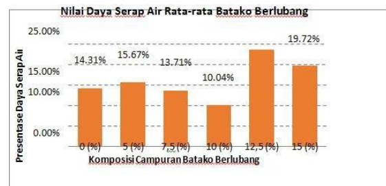
Gambar 1. Grafik Hasil Pengujian Daya Serap Air Rata-rata Batako Berlubang
