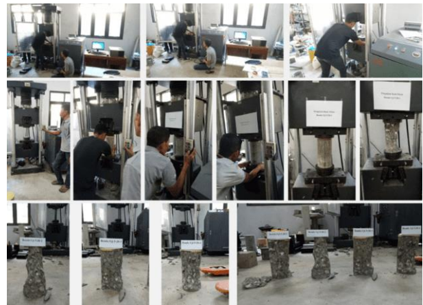
Gambar 14. Proses Pengujian Destruktif Menggunakan Universal Testing Machine
