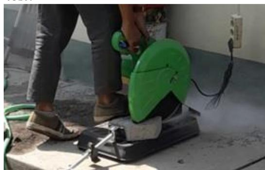
Gambar 4. Pemotongan Benda Uji
