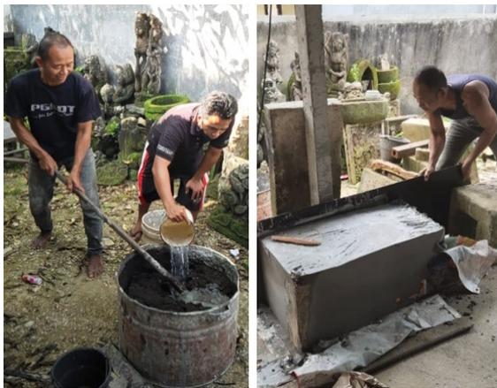
Gambar 1. Proses Pencetakan Balok Batu Padas Artifisial
