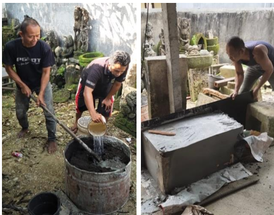
Gambar 1. Proses Pencetakan Balok Batu Padas Artifisial
