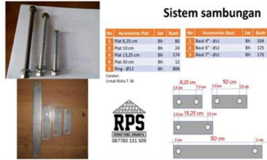
Gambar 7. Komponen Pengikat Antar Panel
