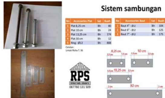
Gambar 7. Komponen Pengikat Antar Panel
