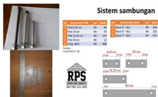
Gambar 7. Komponen Pengikat Antar Panel
