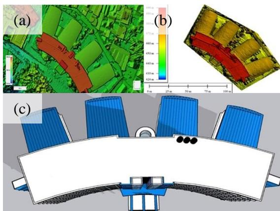
Gambar 4. Representasi Atap Gedung (a) *Digital Surface Model*; (b) *Digital Elevation Model*; (c) Pemodelan Gedung berdasarkan pada *as built drawing*
