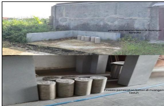
Gambar 1. Proses Perawatan Beton
