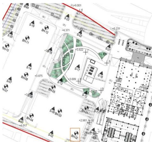
Gambar 1. Denah Titik Sondir
