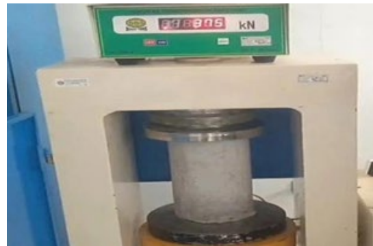
Gambar 10. Proses Uji Kuat Tekan Beton Variasi 1% 28 Hari
