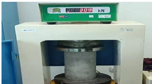
Gambar 9. Proses Uji Kuat Tekan Beton Variasi 1% 14 Hari
