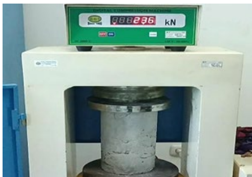
Gambar 11. Proses Uji Kuat Tekan Beton Variasi 2% 14 Hari
