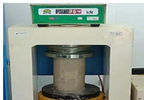
Gambar 8. Proses Uji Kuat Tekan Beton Normal 28 hari
