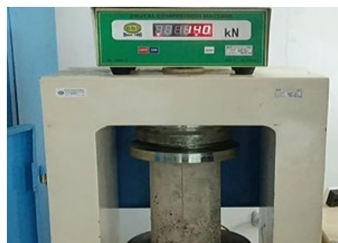
Gambar 13. Proses Uji Kuat Tekan Beton Variasi 3% 14 Hari
