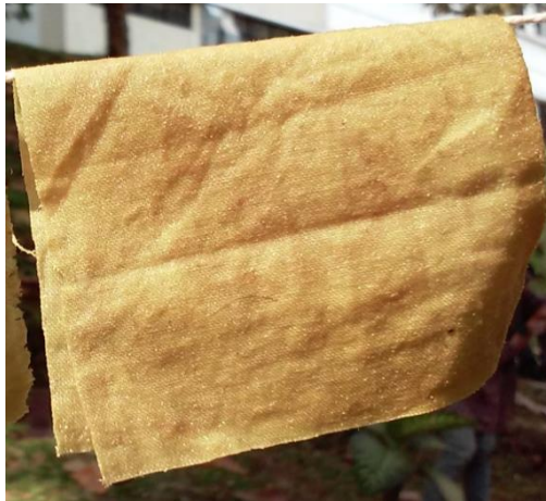
Gambar 1.8 Fiksasi menggunakan Air Kapur (Ca(OH) 2 )
