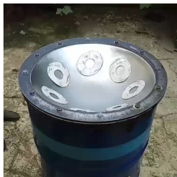
Gambar 9. Pemberian Cetakkan untuk Ding dan Dimple (Sumber: Dokumentasi Daniv Veryana, 2020)
