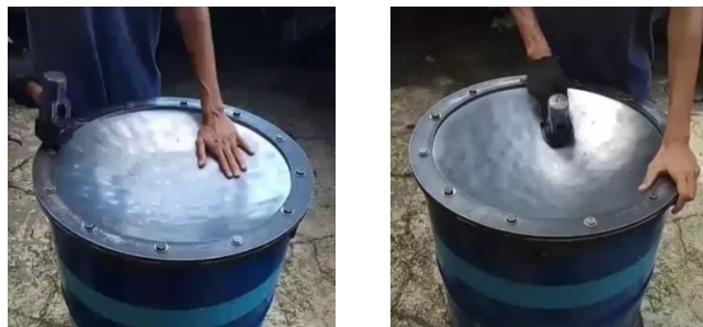
Gambar 8. Proses Memalu dengan palu besar (Sumber: Dokumentasi Daniv Veryana, 2020)
