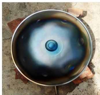
Gambar 13. Proses pengerasan (Sumber: Dokumentasi Instagram @Logamhandpan, 2020)
