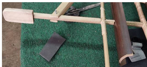
Gambar 4. Pemasangan tuts dengan spon hitam Sumber: Dokumentasi Pribadi, 2022
