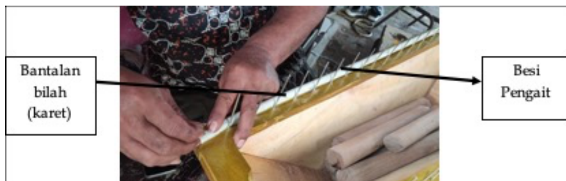
Gambar 2. Konstruksi tempat dudukan gambang
