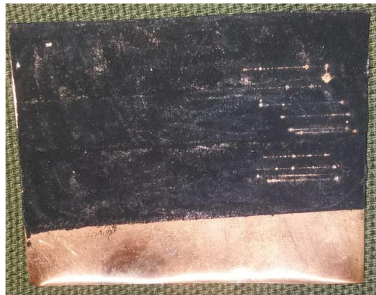
GAMBAR 3. Sampel pelat tembaga + residu dari mesin motor
