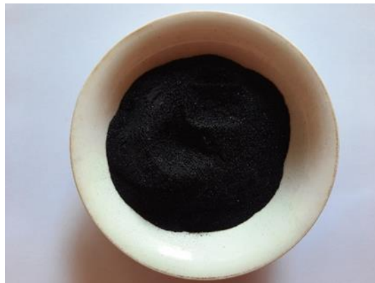
GAMBAR 1. Serbuk arang tempurung kelapa (93 wt. %)
