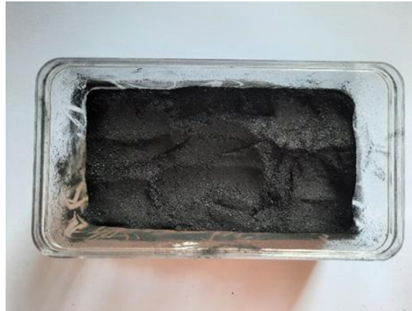
GAMBAR 3. Campuran serbuk arang tempurung kelapa dan perekat tepung tapioka
