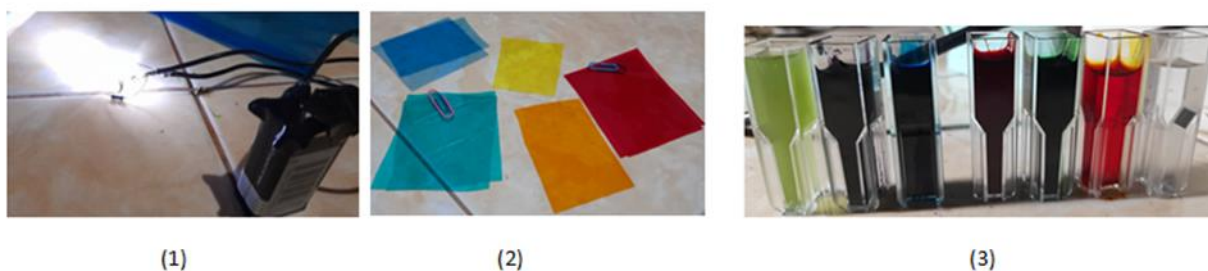
GAMBAR 1. Bahan-bahan yang dibutuhkan untuk perancangan spectrometer: (1) sumber cahaya, (2) filter monokromatis, (3) sampel dan kuvet
